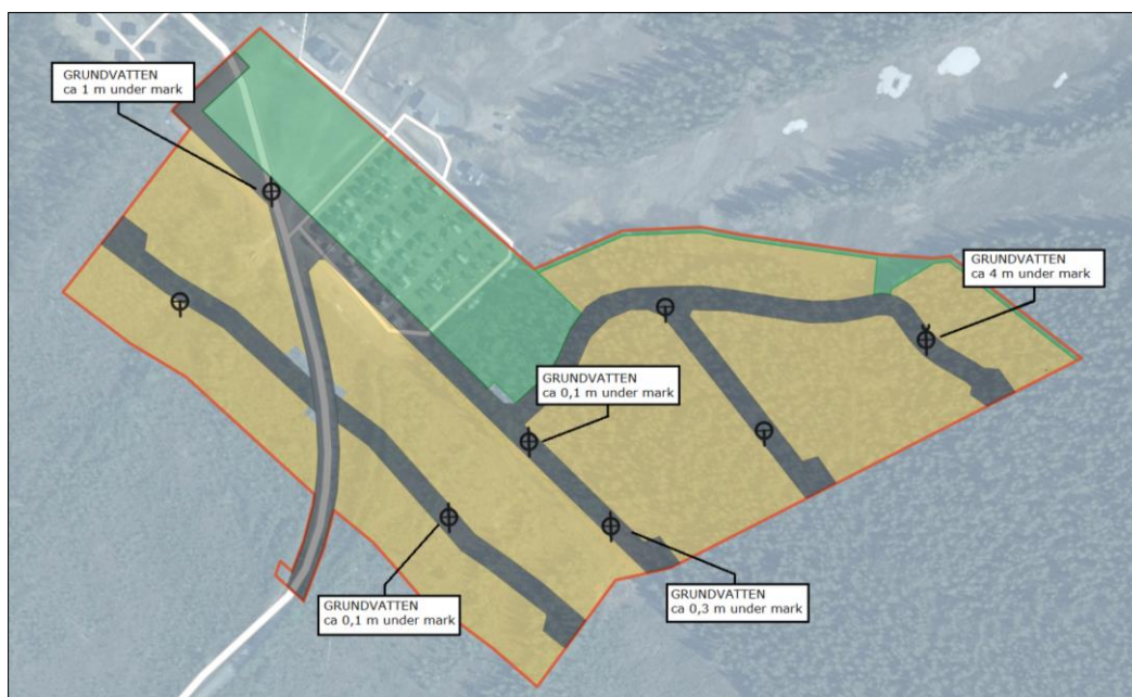
Figur 2-1. Geotekniska undersökningspunkter med uppmätta grundvattennivåer.
